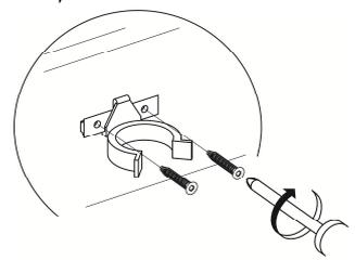
**Рис.9 Схема монтажа клипс на цоколь**
