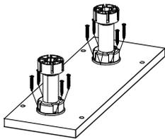
**Рис.5 Схема установки опор**
