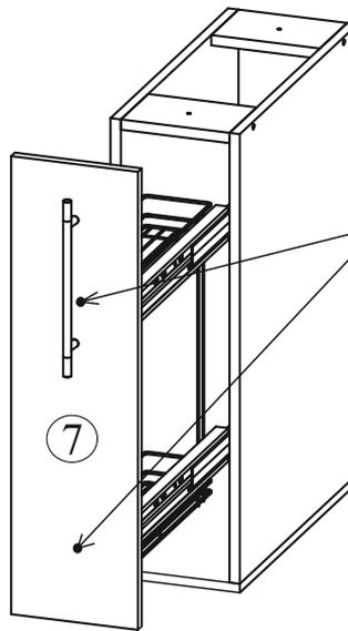
Накладка к бутылочнице (19) крепится с помощью евровинтов 6,3x11,5 (11) с внутренней стороны после регулировки фиксируется с помощью саморезов 3,5x16 (18)
