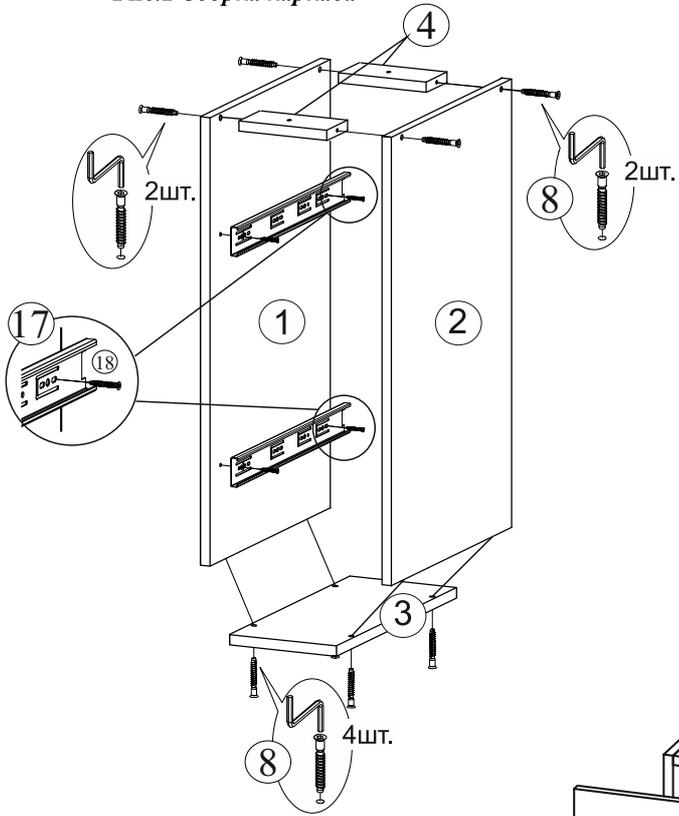
**Рис.3 Монтаж задней стенки**
