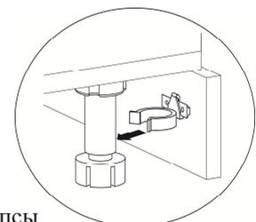
Для установки клипсы (13), планка клипсы прикручивается саморезами 3,5\*16 (18) согласно схеме.
